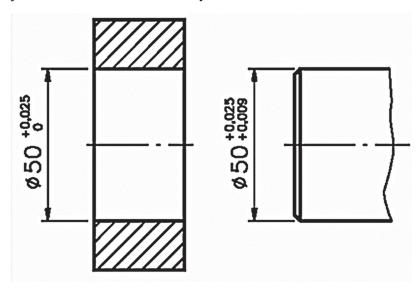
Esse tipo de ajuste indicado para a determinada montagem é um ajuste
